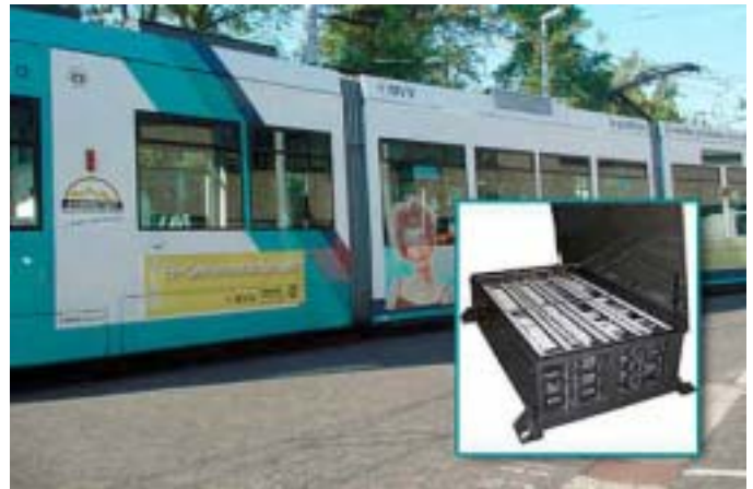
Strassenbahn der Mannheimer MVV Verkehr AG mit der Bombardier Mitrac Energy Saver Lösung
